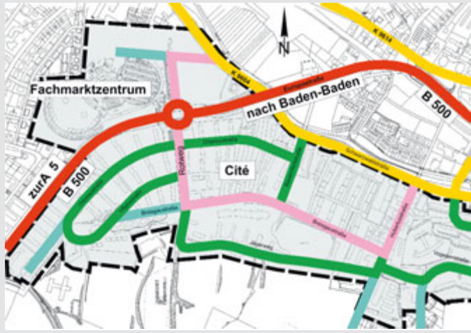
Bild 2: Verkehrskonzept mit Knotenpunkt B 500/ Rotweg
