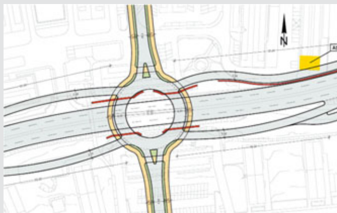
Bild 6: Variante 5, Oben liegender Kreisverkehr
