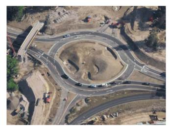
dige Kreisverkehrlösung an - ein kompakter, lediglich einspuriger Kreisverkehr wäre bei der Verkehrs-Frequentierung der B 500 in Spitzenzeiten überlastet gewesen. Von der klassischen zweispurigen Variante rieten deutsche Verkehrsexperten ab, weil sich gerade die zweispurige Ausfahrten als gefährlich herausgestellt haben.
