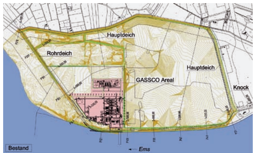
Bild 1: Übersichtsplan des Spülfeldgeländes inklusive der verwendeten Kilometrierung, die dargestellten Höhenlinien weisen eine Differenz von 10 cm untereinander auf
