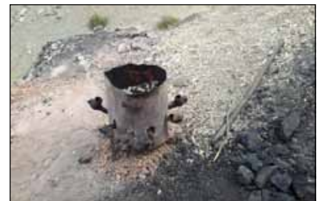
Bild 2: Aufarbeitung der Keilhauen in Asphaltitöfen
