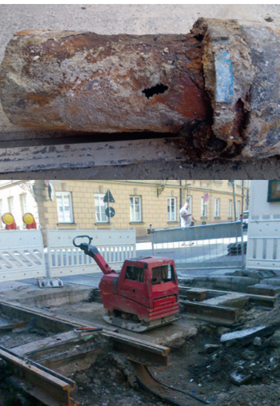
Abb. 3: Schaden an der Trinkwasserleitung DN 150 GGG (duktiler Grauguss) in der Frauentorstraße im August 2013
